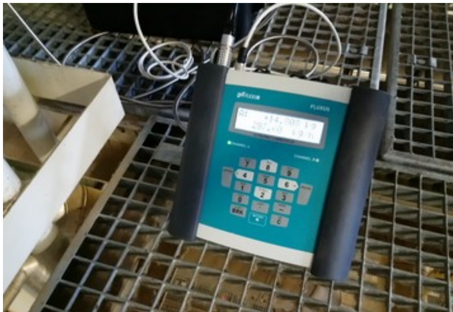
7. kép: Flexim G601ST áramlásmérő a mérési folyamat közben.
