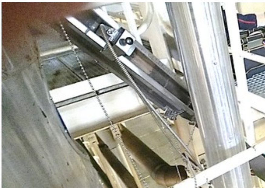
3. kép A telepített szenzor konzol a felkarcolt területtel
