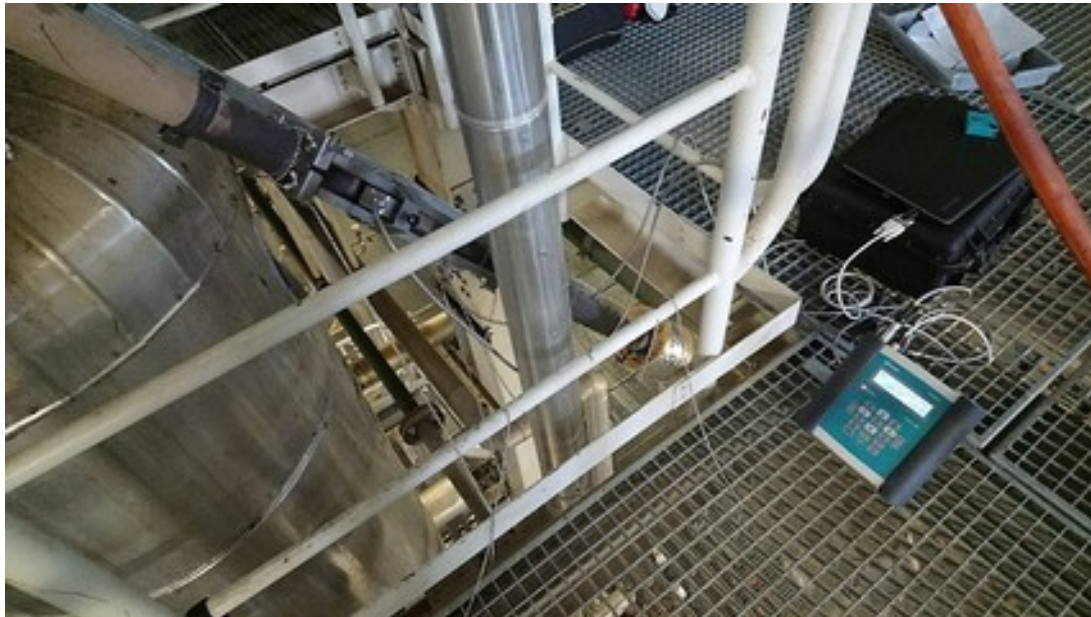
4. kép Az áramlás monitor és érzékelő elrendezkedése
